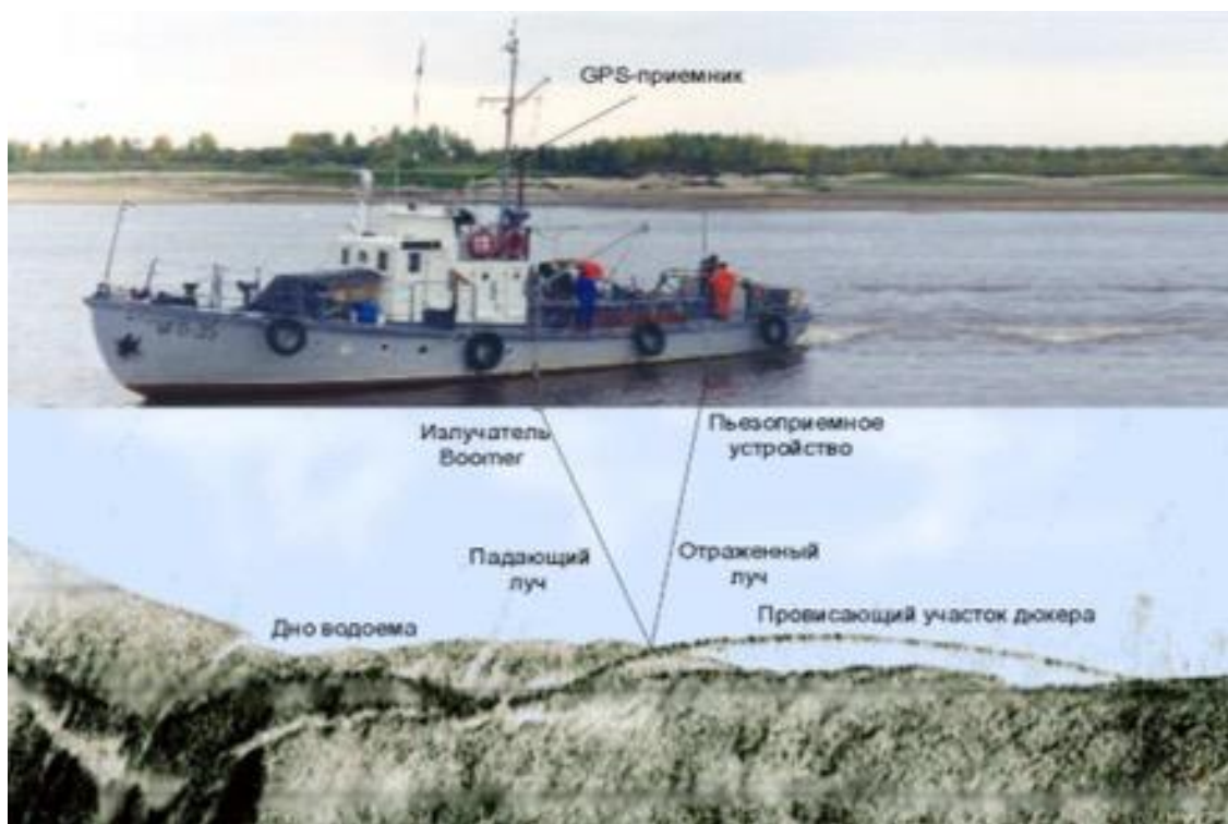
Рис. 3. Схема обследования подводного газопровода методом сейсмоакустического профилирования
