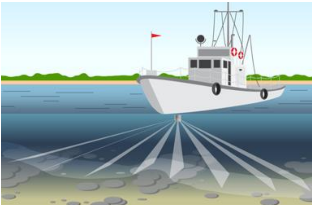
Рис. 1. Обследование дна реки методом гидролокации бокового обзора
